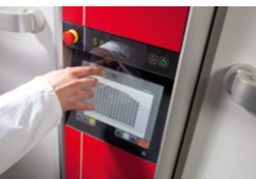
Pantalla táctil con tecnología capacitiva proyectada
