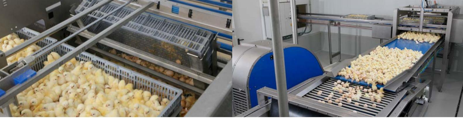
Separação eficiente de pintos de um dia e cascas de ovos
